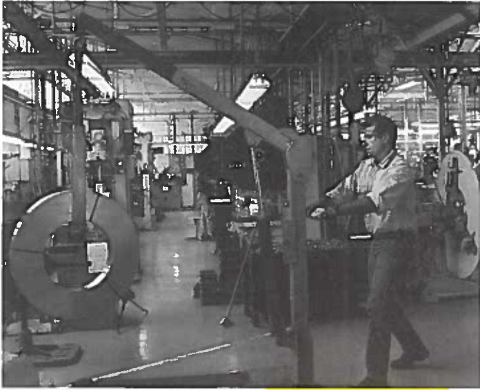
Gérard Adda déplace un rouleau de bande de métal à l'aide d'une «chèvre».
